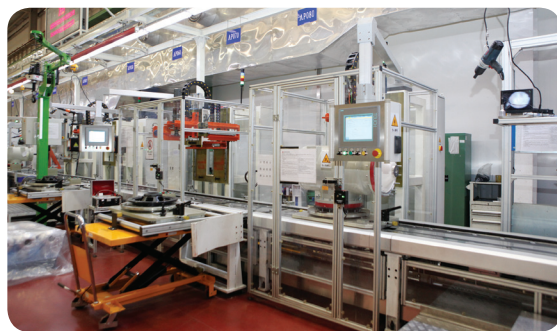
国际开关行业首条 252kV 隔离开关自动化装配生产线
