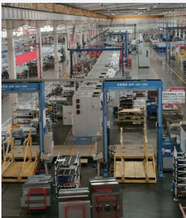
宝鸡电气 开关柜装配3号线和钣金加工柔性 T 线
