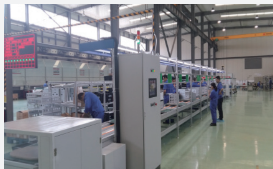
电力系统SVG功率模块连续流装配
