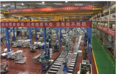
总装生产线和总装三车间 126kV GIS总装生产线
