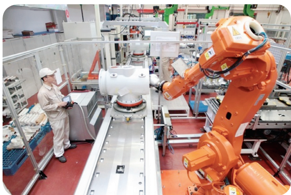
建成国际开关行业第一条 252kV GIS 隔离开关自动化装配生产线
